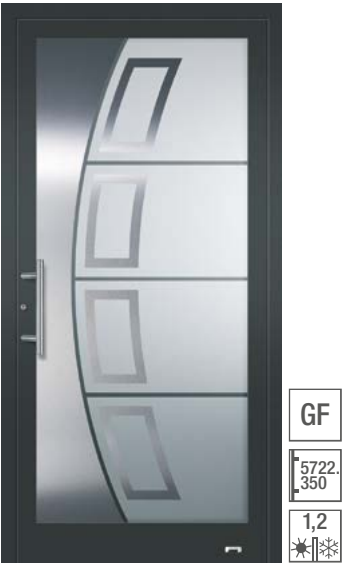
5457 Verglasung: Wärmeschutzisoliertglas, vorne: VSG beschichtet, Mitte: ESG mattiert mit klarem Streifen und NIRO-Applikationen, hinten: ESG, Oberfläche: ca. RAL 7016 Nightgrey FS
