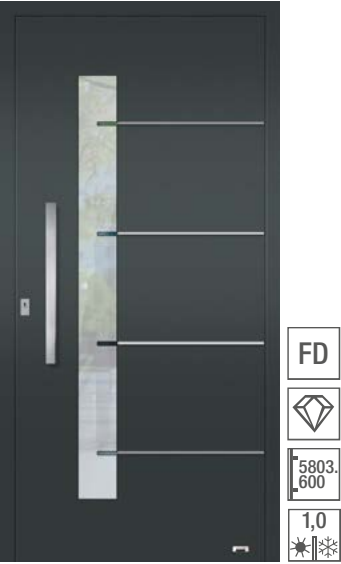
5341 Stoßgriff auf Füllung montiert, vorne: VSG mattiert mit klaren Streifen, hinten: Float beschichtet, Lisenen in NIRO-Design nicht flächenbündig, Oberfläche: ca. RAL 9005 Deep Black FS
