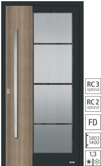
5508 geteilte Sprossen 90 mm, 365 mm breiter Applikation außen aufgebracht, Wärmeschutzisoliertglas, vorne: VSG mattiert mit klarem Rand und Streifen; hinten: Float beschichtet; Oberfläche: Dark FSM;Applikation:An Teak
