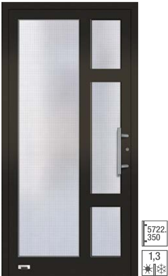
5505 geteilte Sprossen 90 mm, Wärmeschutzisoliertglas, vorne: VSG beschichtet, hinten: Mastercarre, alternativ: Float oder Chinchilla weiß. Oberfläche: Sandbrown FSM
